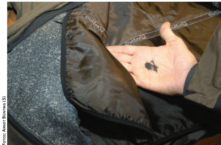
Der Stoff, aus dem der Filter ist: Aktivkohlekügelchen (l.) werden auf einen Trägerstoff laminiert und beispielsweise in der Outfox-Softshelljacke verwendet.
